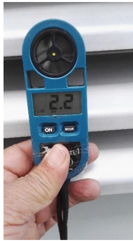
Flujo de los filtros sin cambiar 2.2 m/seg.
