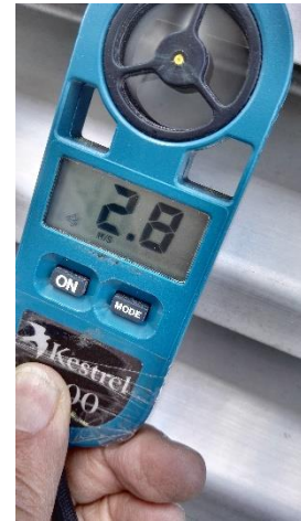
Flujo de los filtros cambiando el MERV 14 2.8 m/seg
